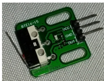
б) при замыкании концевого контакта фиксируется лог. 1;
