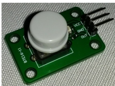
а) при нажатии на кнопку фиксируется лог. 1;
